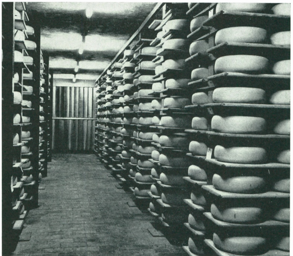
Rijpingslokaal van harde kaas, type Gouda. Warmte en vochtregeling geschieden automatisch
